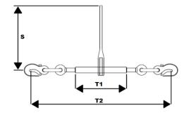
Ratschenlastspanner - mit Ausdrehsicherung und mit 2  $\,$
